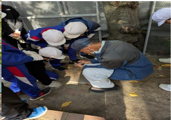
山中式硬度計 24mm 以上（硬い）の部分は土壌改良する
